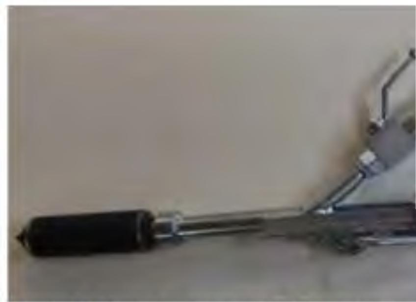
Figur 10 Komplett stav med akseleratormunnstykke (demoversjon med forkortet stav)
