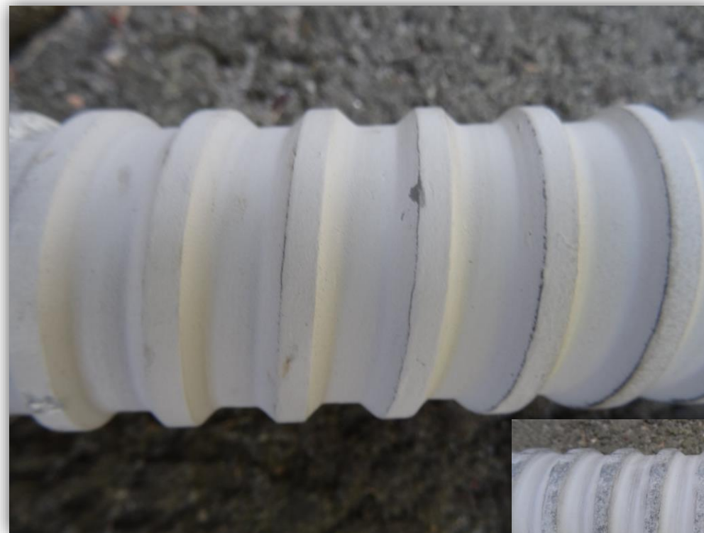
Test-boring med duplex-system Bilder etter 6m og 21m, >100my duplex-coating tilbake
